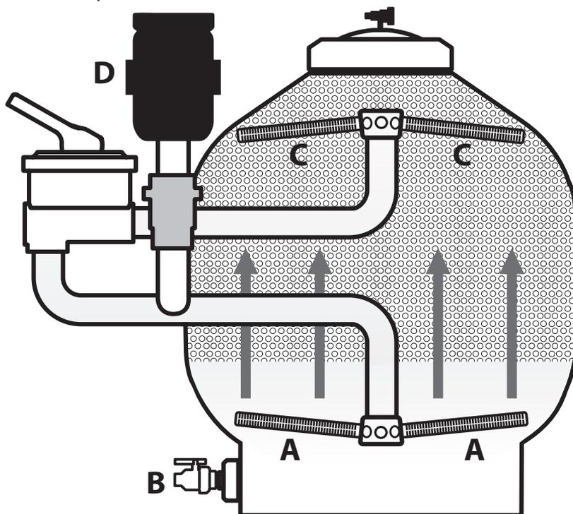
Вода поступает в бак (А) под давлением насоса. Твердые частицы собираются в центре фильтра, ожидая гидравлической очистки под давлением насоса. Все, что вам нужно сделать, это открыть клапан отделения шлама (В) при работающем насосе и фильтре в обычном режиме фильтрации, и более тяжелые твердые частицы будут удалены всего за пару секунд. Что все это значит? Самый уникальный и эффективный фильтр в своем роде. Эффективный фильтр не задерживает твердые частицы, он их удаляет!
