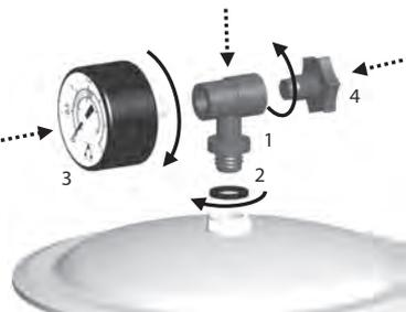
Сборка манометра (с клапаном)
